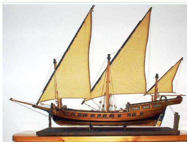
Il nome deriva dall'arabo "sciabah" barca armata con tre alberi a calcese, vele quadre e vele latine, trinchetto inclinato verso prora, maestra verticale e mezzana inclinata verso poppa.
